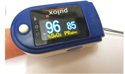
Oxymètre de pouls : outil de surveillance simple complétant la palpation des pouls et l'auscultation des trajets vasculaires en aval d'un traumatisme de membre, à la recherche d'une ischémie.
